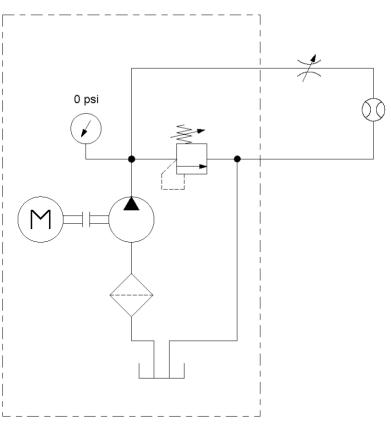
Figure 3. Flow Meter Schematic
